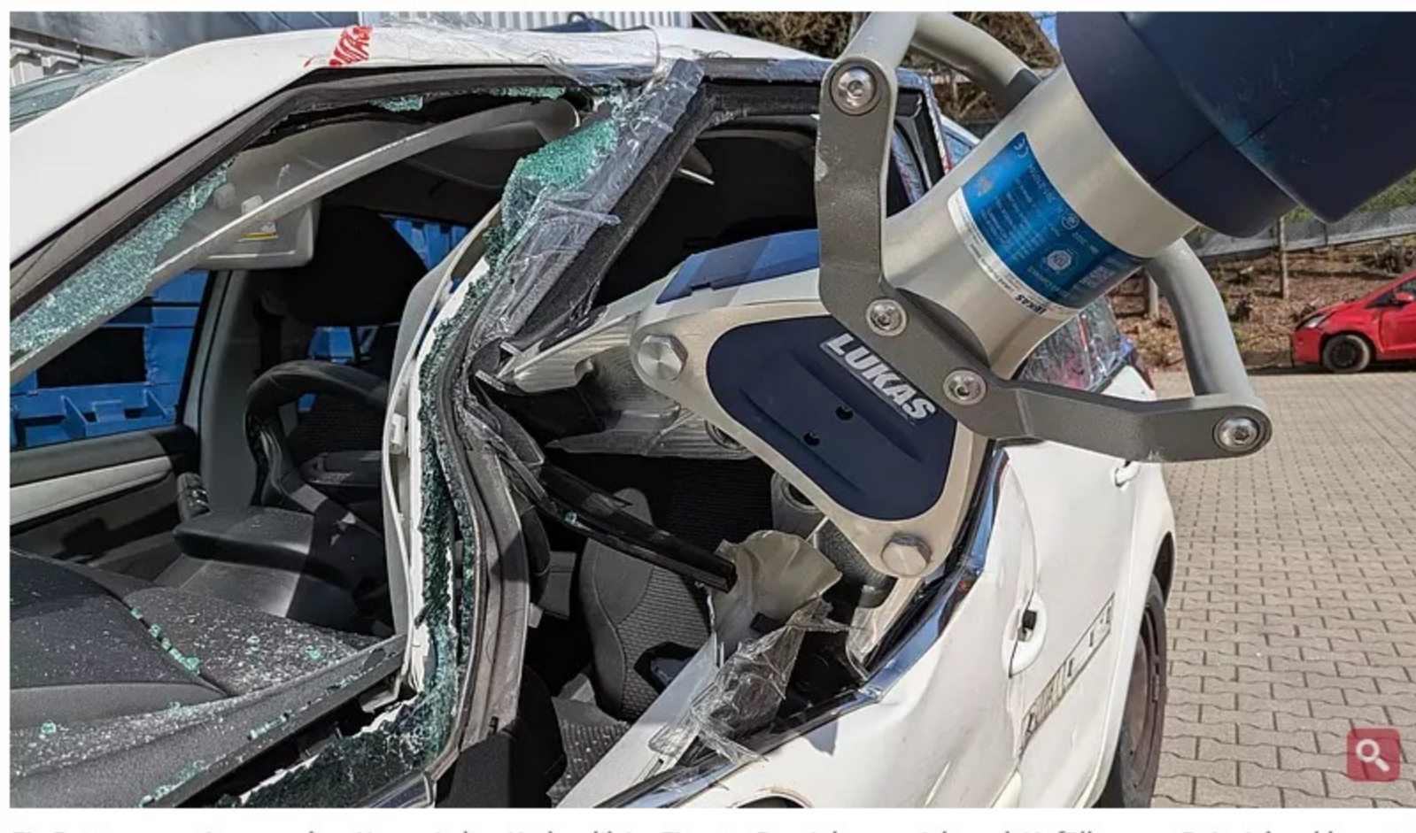
Ein Rettungsspreizer aus dem Hause Lukas Hydraulik im Einsatz. Damit lassen sich nach Unfällen zum Beispiel verklemmte Türen von Autos aufdrücken. //
