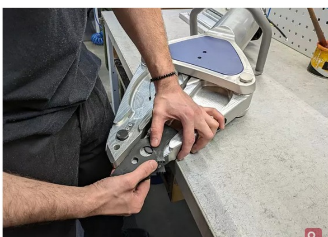
Bei Lukas Hydraulik in Erlangen werden die Einzelteile von Hand montiert, so wie bei diesem Rettungsspreizer. // Martin Regner
