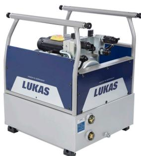
Die kraftvollen Motorpumpen der Serie 650 versorgen all Ihre Geräte aus dem LUKAS Aufgleissystem mit der nötigen Power für Ihr Projekt. Der Einsatz von Zwei- oder auch von Vier-Strom-Radialkolbenpumpen ist möglich. Je nach Bedarf können bis zu vier Hydraulikzylinder mit gleichen Förderströmen versorgt werden. Manövrieren Sie synchrones Aus- und Einfahren baugleicher Hubzylinder über den Steuertisch.
