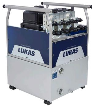
Die kraftvollen Motorpumpen der Serie 650 versorgen all Ihre Geräte aus dem LUKAS Aufgleissystem mit der nötigen Power für Ihr Projekt. Der Einsatz von Zwei- oder auch von Vier-Strom-Radialkolbenpumpen ist möglich. Je nach Bedarf können bis zu vier Hydraulikzylinder mit gleichen Förderströmen versorgt werden. Manövrieren Sie synchrones Aus- und Einfahren baugleicher Hubzylinder über den Steuertisch.
