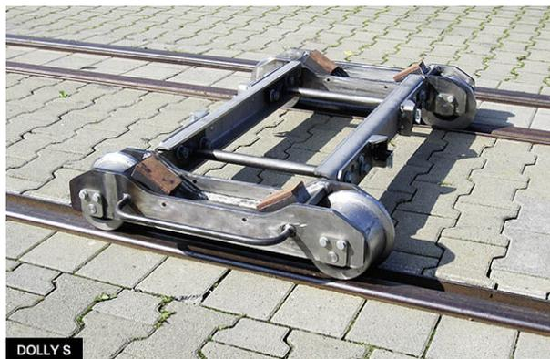
Blockierte oder defekte Schienenräder und Radsätze von Schienenfahrzeugen müssen schnell von der Gleisanlage geborgen und in die Werkstatt transportiert werden. Der LUKAS Abschleppwagen DOLLY hilft Ihnen dabei ohne Beschädigung von Rollmaterial und Gleisinfrastruktur.
