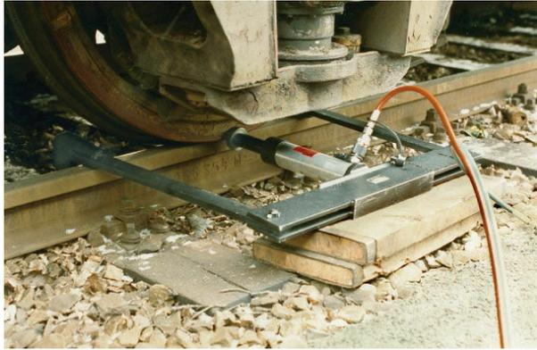
Stehen Fahrzeugräder mit dem Spurkranz auf der Schiene, drückt sie der Achseindrücker in die Spur. Zusätzlich benötigen Sie den Zylinder LFM 10/160 und die passende Kolbenschutzplatte.
