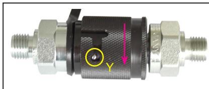
Antes de efectuar el acoplamiento, retire los protectores contra el polvo y, a continuación, empuje hacia atrás el casquillo de enclavamiento del manguito (posición X) y manténgalo en esta posición. Conecte el racor y el manguito y suelte el casquillo de enclavamiento. A continuación, gire el casquillo de enclavamiento a la posición Y. La conexión se ha completado y asegurado. El desacoplamiento se efectúa en la secuencia inversa.
