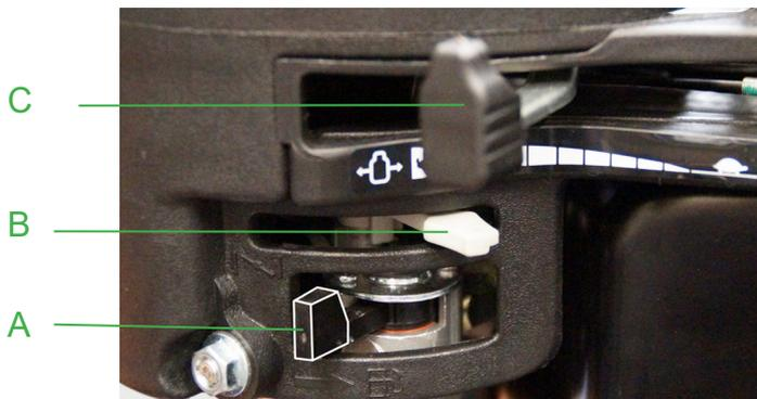
1. Abra la llave de la gasolina "A": Empuje la palanca hacia la derecha hasta el tope.
