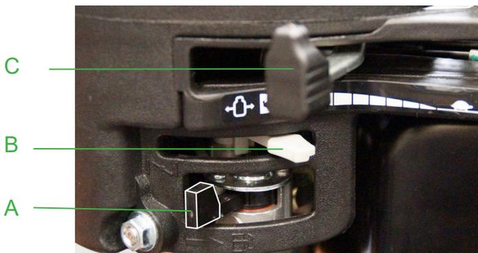
1. Benzinhahn „A“ öffnen: Hebel nach rechts bis zum Anschlag schieben.
