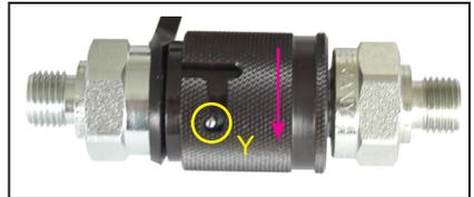
Vor dem Kuppeln Staubschutzkappen abnehmen, dann Verriegelungshülse der Muffe (Position X) zurückziehen und halten. Nippel und Muffe zusammenstecken und die Verriegelungshülse loslassen. Abschließend die Verriegelungshülse in Position Y drehen. Die Verbindung ist nun hergestellt und gesichert. Das Entkuppeln erfolgt in umgekehrter Reihenfolge.
