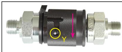
Avant le couplage, retirer les capuchons anti-poussière puis tirer en arrière et maintenir la douille de verrouillage du coupleur femelle (position X). Assembler le coupleur mâle et le coupleur femelle, puis relâcher la douille de verrouillage. Tourner ensuite la douille de verrouillage en position Y. Le raccord est ainsi établi et sécurisé. Le découplage se fait dans l'ordre inverse.
