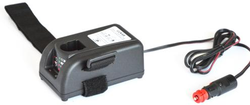
Schnellladegerät für 2,4V bis 28,8V bzw. 7,2 - 18,0V Ni-Cd/ Ni-MH/ Li-Ion Akkupacks. Microprozessorgesteuertes Laden, Ladezeiten 30-150 min., abhängig von der Kapazität des Akkus (1,5Ah - 7,5Ah).
