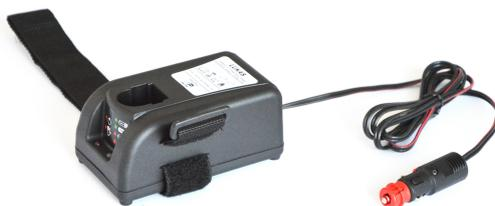
Caricabatterie rapido per batterie Ni-Cd/ Ni-MH/ Li-Ion da 2,4V - 28,8V/ 7,2V - 18V. Ricarica assistita da microprocessore, tempi di ricarica 30-150 min. a seconda della capacità della batteria (1,5 Ah - 7,5 Ah).
