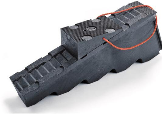
Die LUKAS Unterlagen dienen zum sicheren Unterbauen von Fahrzeugen und Abstützen von Lasten bei Rettungsarbeiten. Sie verhindern gefährliche Eigenbewegungen von Unfallfahrzeugen, die durch Einsatz von Schere und Spreizer ihre Stabilität verlieren.
